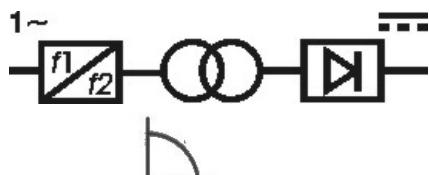
Convertidor estático de frequência monofase-transformador retificador.
