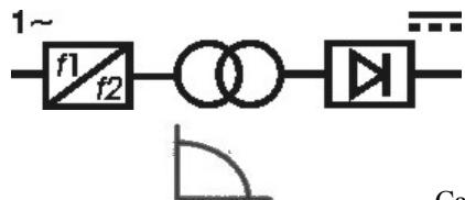
Convertitore statico di frequenza monofase-trasformatore raddrizzatore.
