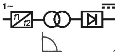
Convertidor estático con frecuencia monofase transformador rectificador.
